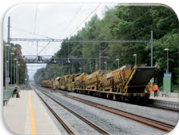
Optimalizace železniční tratě pomocí strojní linky RPM 2002
